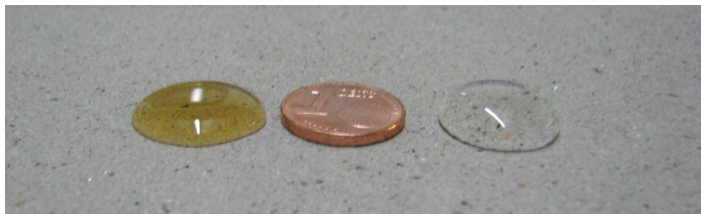
Защищено COLORTEC® Max , слева масло, справа вода
